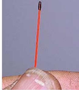
*Отрезок силиконовой трубки работает как инструмент точной огрузки на некоторых поплавках Стива.*
