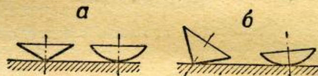
Рис. 7. Контроль блесны после штамповки: а — правильно отштампованная блесна. б — штамповка с перекосом (брак)
