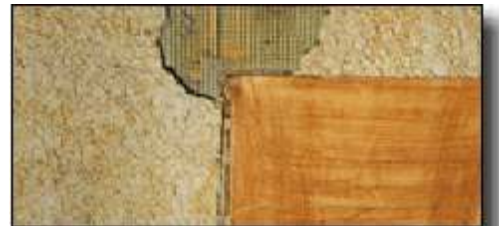
Фрагмент образца с экструдированным пенополистиролом перед демонтажем.
