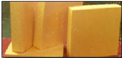
образец эструдированного пенополистирола
