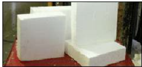
образец блочного пенополистирола (ПСБ-С 25)
