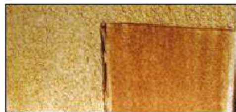
Фрагмент образца с пенополистиролом после 700 циклов испытания перед демонтажем.
