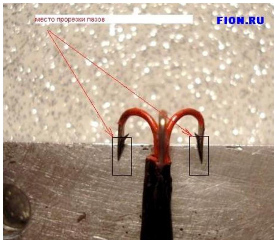
Теперь самое ответственное! Как обеспечить пролив свинца в нижнюю часть чертика. Я люблю узкие чертики, рыбе нравится. Но! ..Если учесть, что диаметр в узкой части 2 мм, а толщина даже тонкого тройника с припаянной проволокой, минимум 1,5 мм , зазор для протекания свинца ноль целых хрен десятых.
