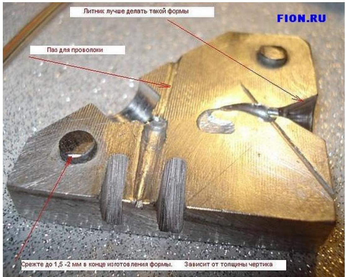
когда мы заливаем свинец, воздух должен вытесняться из формы. Если нет выхода, он не даст свинцу пролиться до конца (чем точнее форма, тем критичнее ).
