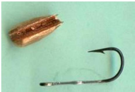
Фото 9. Заготовка тела медной мормышки и облуженный крючок
